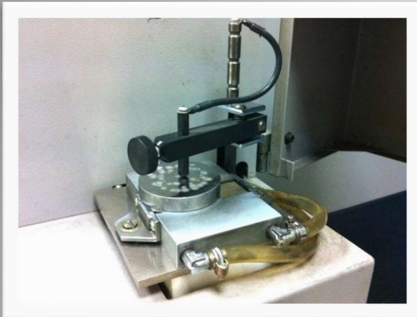
-1 SPECTROMETRE de masse à étincelage ARL type 3460
